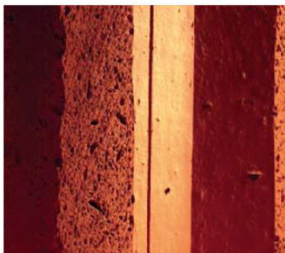
Рис. 6. Поризованная структура черепка
